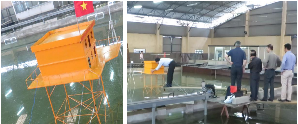
Hình 4.6. Gắn và kết nối đầu đo gia tốc với thiết bị đo
