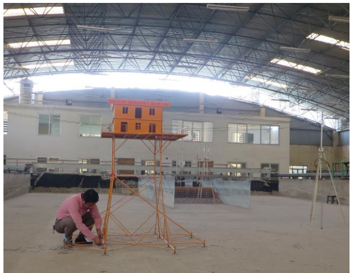
Hình 4.7. Chế tạo mô hình giàn tại xưởng và bố trí trong bể tạo sóng
