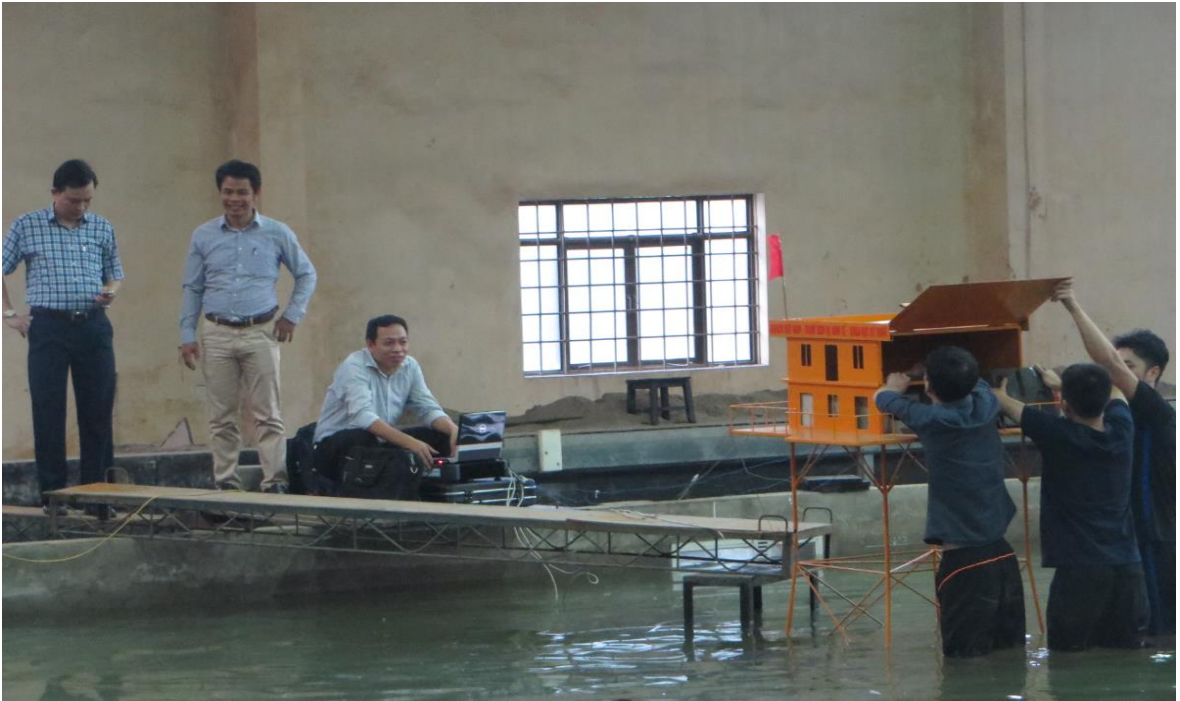
Hình 4.14. Gia tải trong quá trình thí nghiệm tại bể tạo sóng
