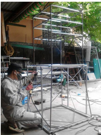
Hình 4.7. Chế tạo mô hình giàn tại xưởng và bố trí trong bể tạo sóng
