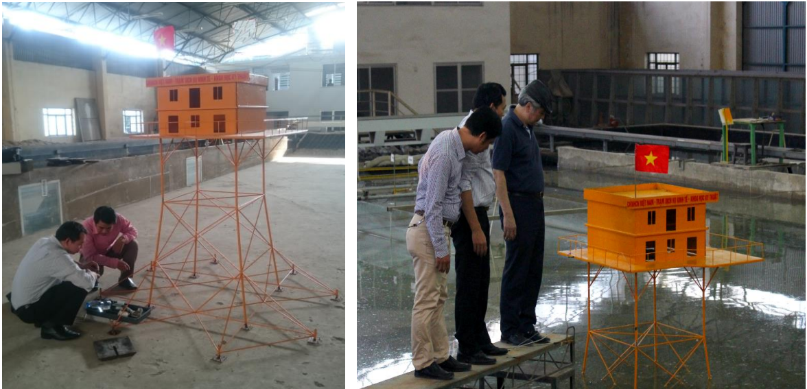
Hình 4.2. Mô hình thí nghiệm trước và sau khi bơm nước vào bể tạo sóng
