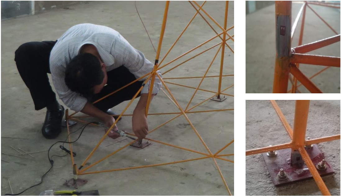
Hình 4.5 Gắn tấm điện trở đo biến dạng theo phương trục dọc thanh giàn
