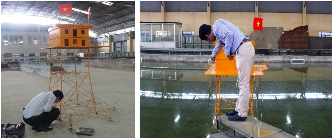
Hình 4.8. Gắn đầu đo động trên kết cấu mô hình giàn
