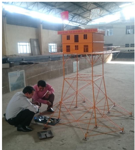
Hình 4.2. Mô hình thí nghiệm trong bể tạo sóng
