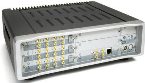
Hình 4.4. Thiết bị đo động LMS và màn hình hiển thị kết quả
