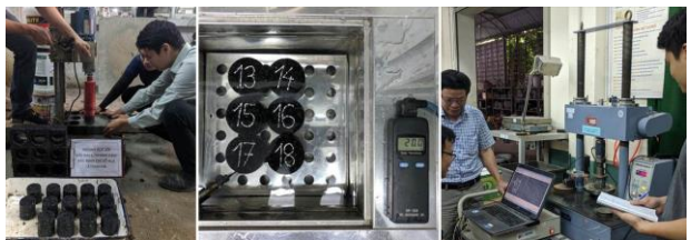
Hình 3.17. Khoan rút lõi, ngâm và nén mẫu ở 50°C và 20°C
