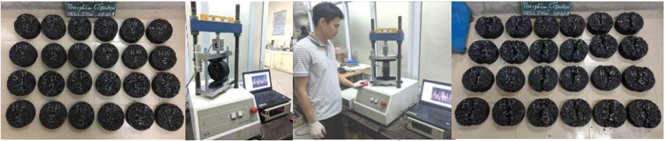
Hình 3.27. Thí nghiệm xác định chỉ số kháng nứt CT_{Index}
