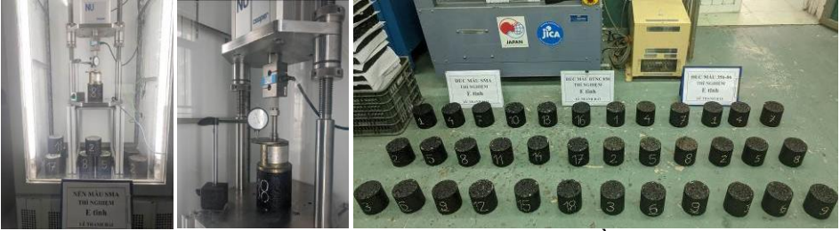
Hình 3.37. Thí nghiệm xác định mô đun đàn hồi tĩnh
