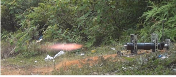
Hình 3.24. Động cơ mẫu hoạt động trong quá trình thử nghiệm
