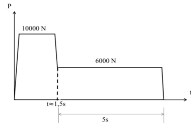
Hình 4.42. Đồ thị lực đẩy dạng đơn xung của động cơ hành trình
