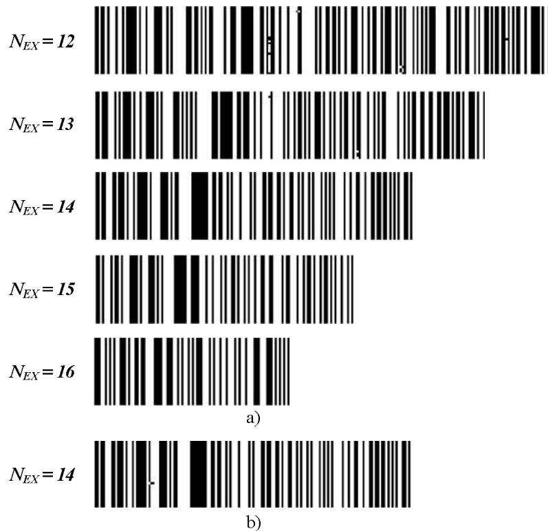
Hình 4.6: Ảnh nhị phân minh họa sự phụ thuộc của tính ổn định chuỗi bit ra vào số bit loại bỏ (a) và kiểm nghiệm độ ổn định với N_{EX} = 14 (b).
