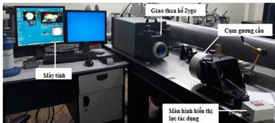
Hình 2.5. Mô hình thiết bị đo quang sai mặt sóng của gương cầu.
