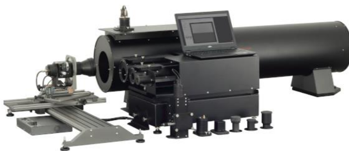
Hình 1.11. Sơ đồ đánh giá chất lượng ảnh của HTQH bằng thiết bị ORI
