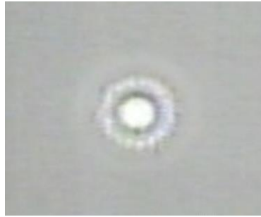
Hình 4.17. Ảnh của lỗ nhỏ có đường kính 10 \mu\text{m}
