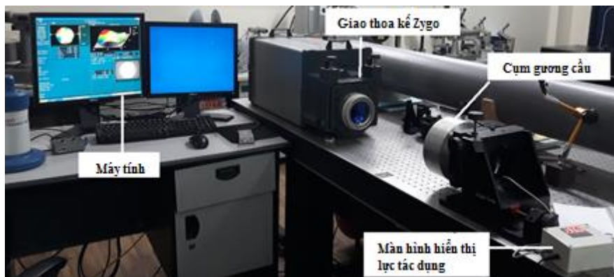
Hình 2.4. Mô hình thiết bị đo quang sai mặt sóng của gương cầu.
